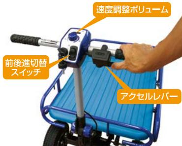
アクセルレバーを押せばスタート! 速度調整ボリュームでスピード調整も簡単!坂道でもアクセルレバーを離すと止まる**電磁ブレーキ**を装備。安全にも配慮しています。
