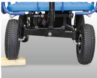
凸凹路面でも追従しやすい**センターピボット方式**を採用!ノーパンクタイヤ採用!
